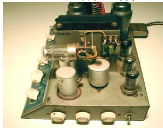
MV 28 mit AM-Rundfunk-Empfangsteil
