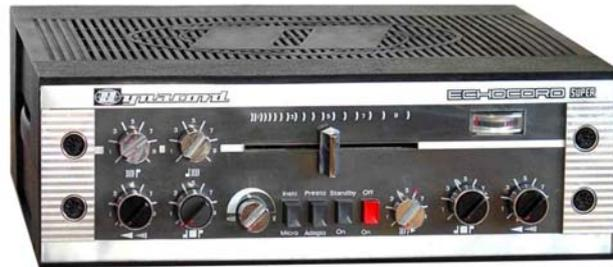
Das 1968 auf dem Markt erschienene neuentwickelte volltransistorisierte ECHOCORD SUPER 75 löst das bis dahin gebaute Vollröhrenmodell ECHOCORD SUPER 65 ab. Die Ära der seit 1960 gebauten Röhrengeräte geht damit zu Ende.
